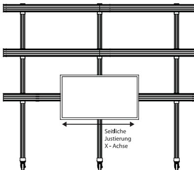
Hinweis: Beim quer montieren von 3 oder mehr Bildschirmen, montieren Sie den ersten Bildschirm mittig auf die untere Schiene.
