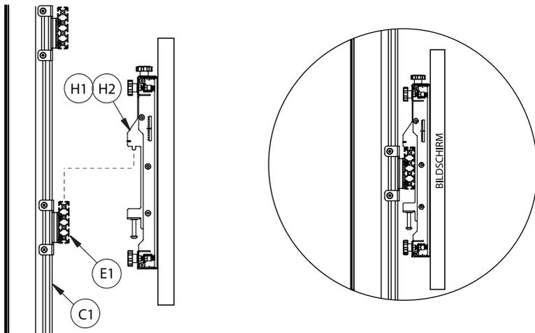
ii. Mit einer Wasserwaage richten Sie den Bildschirm zum Boden aus, indem Sie die höhenjustierbaren Schrauben/Knöpfe am oberen Rand des Interface Arms nutzen.
