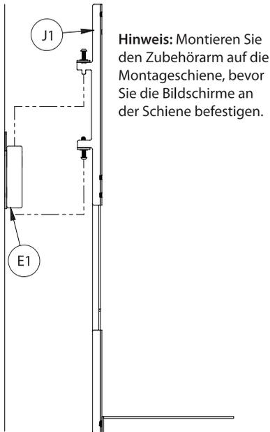
**Hinweis:** Montieren Sie den Zubehörarm auf die Montageschiene, bevor Sie die Bildschirme an der Schiene befestigen.
