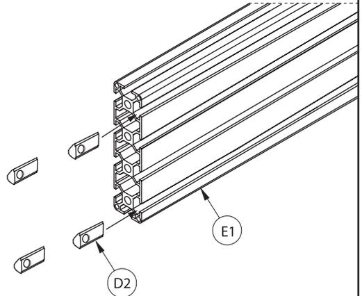
iii. Montieren Sie Artikel D1 an Artikel E1, indem Sie Artikel D3 auf Artikel D2 festziehen.
